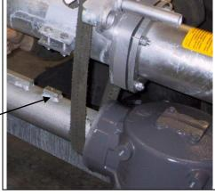
Для смазывания подшипников вала труба привода может быть заполнена доверху маслом типа Shelll HDS 1/20 через расположенный сбоку трубы запорный болт (количества приведены в технических характеристиках).
