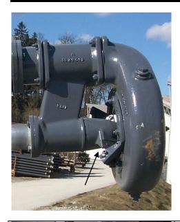
Проверять режущие кромки ножей. Конструкция ножей позволяет использовать их многократно до полного износа. После демонтажа ножа при повторной установке следует
