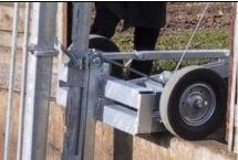
После наклона насоса снова вставить и зафиксировать чеку устройства наклона.
