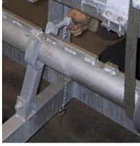
Уложить насос с трубой привода вниз, на держатель подъемного шасси.
