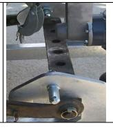
Штифты подъемного шасси навесить на нижние рычаги гидравлики трактора (зафиксировать шплинтами)
