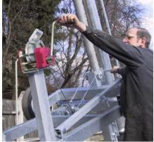
Теперь медленно повернуть насос при помощи лебедки и опустить его подъемом рычага фиксации.
