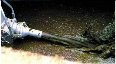
Насос опустить настолько, чтобы форсунка мешалки погрузилась под верхний слой.
